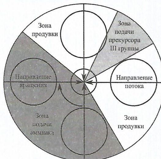
Рис. 1. Схема распределения газовых потоков внутри реактора (вид сверху)
