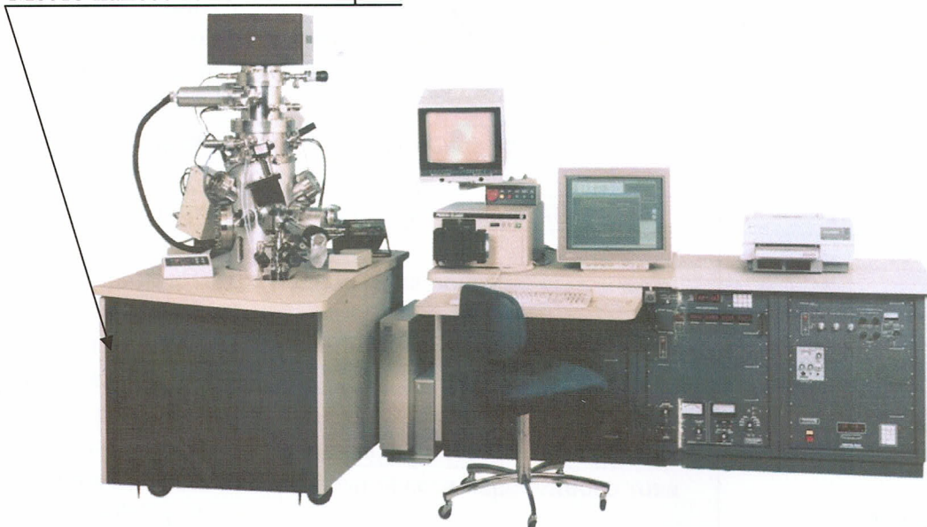
Рисунок 1 - Общий вид спектрометра оже-электронного PHI-670xi
